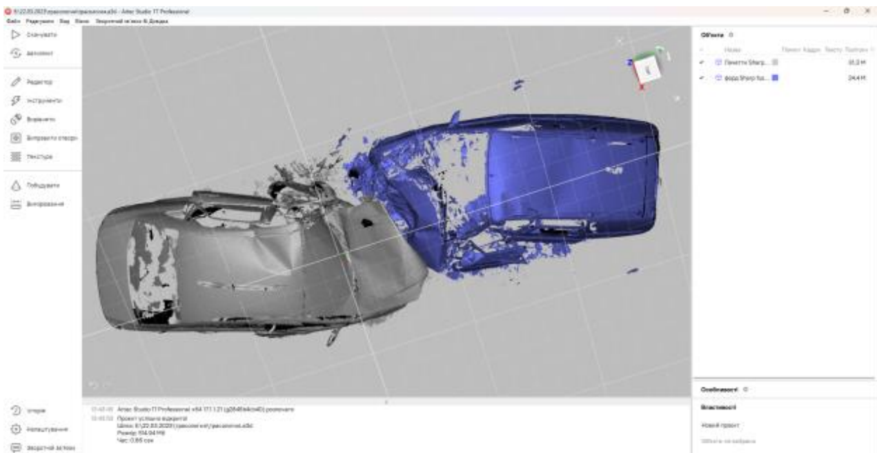
Рис. 2 – Співставлення транспортних засобів з урахуванням їх відсканованих механічних пошкоджень
