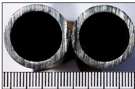
Рис. 11. Співставлення площин розділення обрізу рушниці з частиною ствола.
