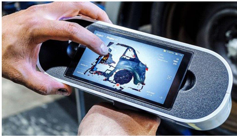
Рис. 1 – Застосування 3D-сканеру Artec Leo
