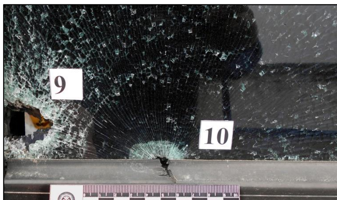
Рис. 2. Вигляд кульового пошкодження на склі (з зовнішньої сторони).
